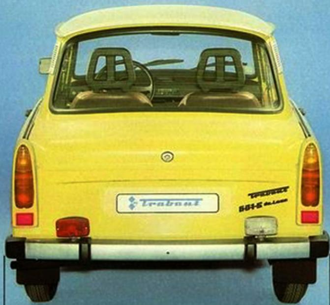
Sie sitzen in einem sicheren, wendigen und schnellen Allgebrauchs-Wagen der 600 ccm-Klasse. Verstellbare Kopfstützen und Rollgurte sind wahlweise eingebaut. 19,1 KW (26-DIN-PS) bringt der luftgekühlte Zweizylinder-Zweitaktmotor. Er fährt bequem 100 km/h, hat 4-Gang-Stockschaltung und fährt mit Kraftstoffgemisch 1 : 50.
