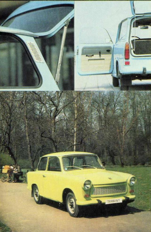
Přední náhon zajišťuje Trabantu 601 mimořádnou stabilitu v zatáčkách. Dvoutaktní bezventilový motor o výkonu 19,1 kW (26 k) je chlazen vzduchem. Palivová nádrž má obsah 24 litrů. Samonosná karoserie z plastické hmoty je zavěšena na plošinovém ocelovém rámu a odpérována listovými pery a teleskopickými tlumiči na předních i zadních kolech.
