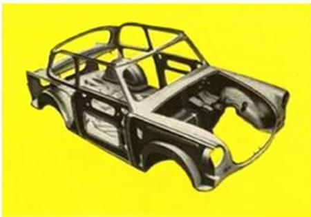
Die formschöne, nach neuen internationalen Geschmackstendenzen entwickelte selbsttragende Ponton-Karosserie in flüssiger Linienföhrung bietet 4 erwachsenen Personen bequem Platz. Das mit der Bodentragplatte verschweißte Stahlblechgerippe zeichnet geringes Eigengewicht und erhöhte Stabilität aus. Die Außenhaut besteht aus dem nunmehr tausendfach bewährten und unter allen klimatischen Bedingungen erprobten Duroplast-Karosseriebaustoff.
