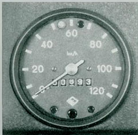
Darüber hinaus signalisiert die zusätzlich angebrachte Kraftstofffüllstandanzeige über eine Leuchte im Tachometer, wenn ein Kraftstoffstand von 6 Liter erreicht ist.
