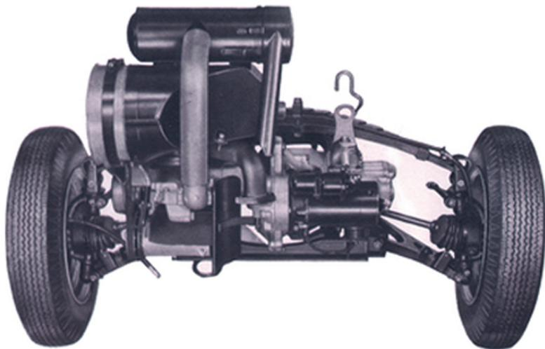
Hier haben Sie den gesamten Fahrschemel vor sich. Motor, Getriebe Achsantrieb, alles ist auf einem zweckentsprechend gestalteten Rahmen montiert. Lediglich zwei Dreischraubenflansche, als Verbindung mit dem Plattformrahmen, sind zu lösen und der gesamte Frontriebwerksatz kann aus der angehobenen Karosserie herausgehoben werden. Einfacher geht es nicht, und - es hilft Zeit und Geld sparen.
